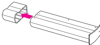
**Attention :** Replacez toujours la protection en plastique sur les bornes de la batterie lorsque vous ne l'utilisez pas.
