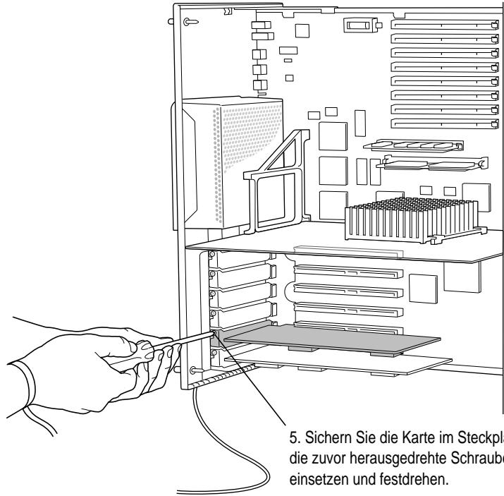
5. Sichern Sie die Karte im Steckplatz, indem Sie die zuvor herausgedrehte Schraube wieder einsetzen und festdrehen.
