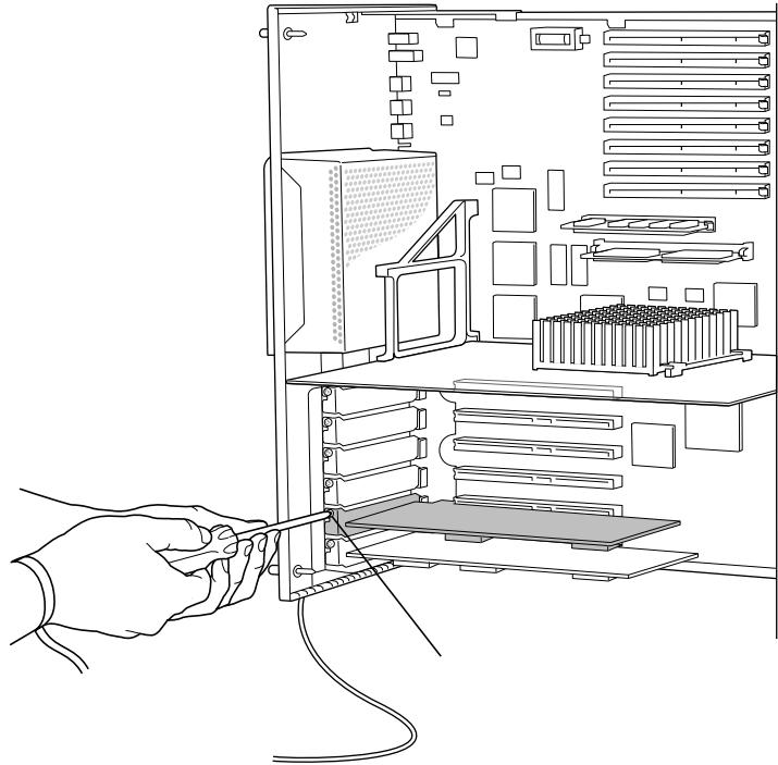
Une fois la carte installée, replacez le module logique dans son compartiment, serrez les vis à molette, placez la clé en position horizontale pour verrouiller le tiroir arrière et reconnectez tous les câbles. N'allumez pas l'ordinateur avant d'avoir connecté la carte au réseau.
